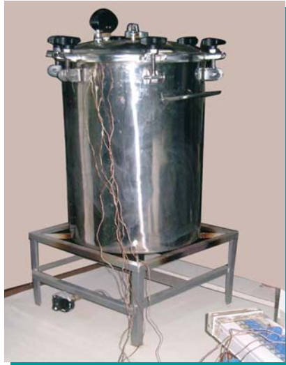
FIGURA 1. Autoclave y sistema de adquisición de temperaturas empleados durante la pasteurización de las mermeladas.
