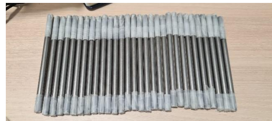
Figura 5. Probetas con los extremos de estas recubiertas de cinta adhesiva.
