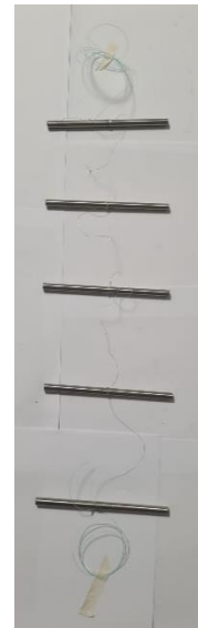
Figura 4. Aparejo para introducir las probetas en la Rivera
