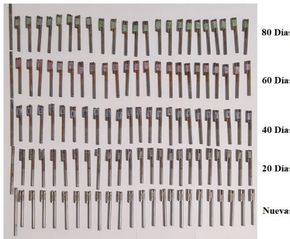
Figura 9. Probetas de laboratorio a las que se les ha realizado el ensayo de fatiga
