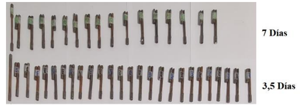
Figura 10. Probetas después de haber estado en la Rivera de Aguas Agrias, a las que se les ha realizado el ensayo de fatiga.
